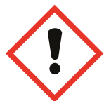
Health hazard Gesundheitsgefahr Danger pour la santé
