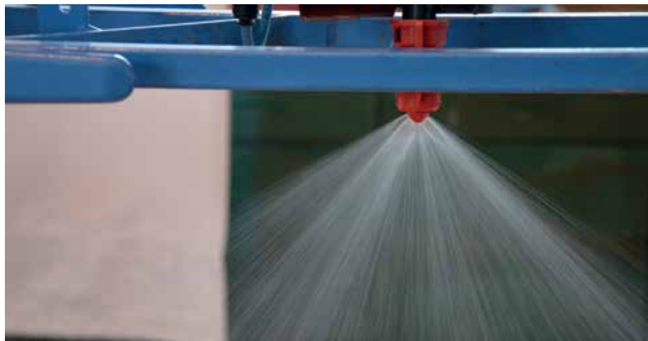
Správný výstřikový obrazec dvouštěbinové trysky
