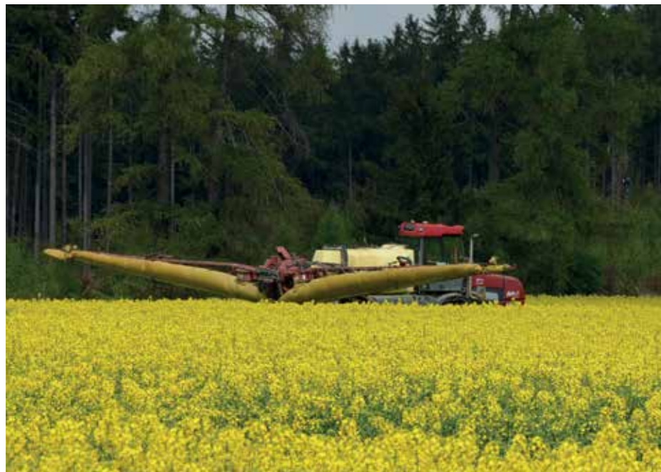
Postřikovač se systémem podpory vzduchem
