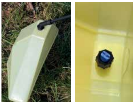
Speciální kryt trysek pro aplikaci herbicidů a detail trysky uvnitř krytu
