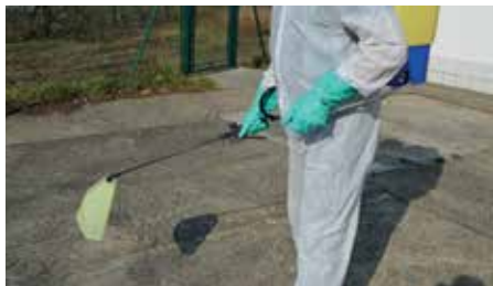
Speciální kryt trysek pro aplikaci herbicidů – zabraňuje úletu postřikové kapaliny
