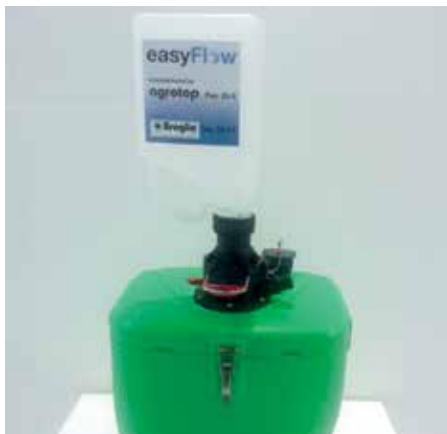
Systémy bezkontaktního plnění přípravků na ochranu rostlin do nádrže postřikovače
