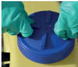
Všechny spoje a uzávěry zádového postřikovače musí být těsné
