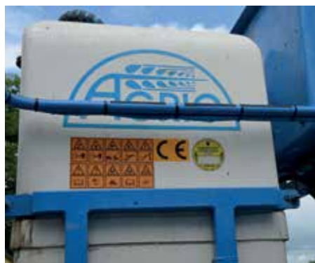
Známka kontrolního testování a její umístění na postřikovači
