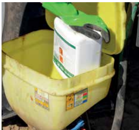
Výplachování prázdného obalu od přípravku na ochranu rostlin za pomoci vyplachovacího zařízení
