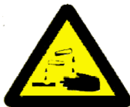
Výstraha, riziko koroze nebo poleptání
