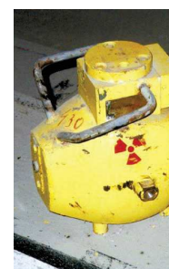
Hladinoměr, tzv. prasátko (nejčastěji ^{137}\text{Cs} )
