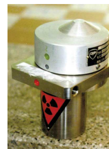
Popeloměr (obsahuje dva ZIZ – ^{241}\text{Am} , ^{137}\text{Cs} )
