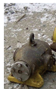
Hladinoměr, tzv. prasátko (nejčastěji ^{137}\text{Cs} )
