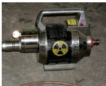
Defektoskopický pracovní kryt typ GAMMAMAT ( ^{192}\text{Ir} , ^{75}\text{Se} )
