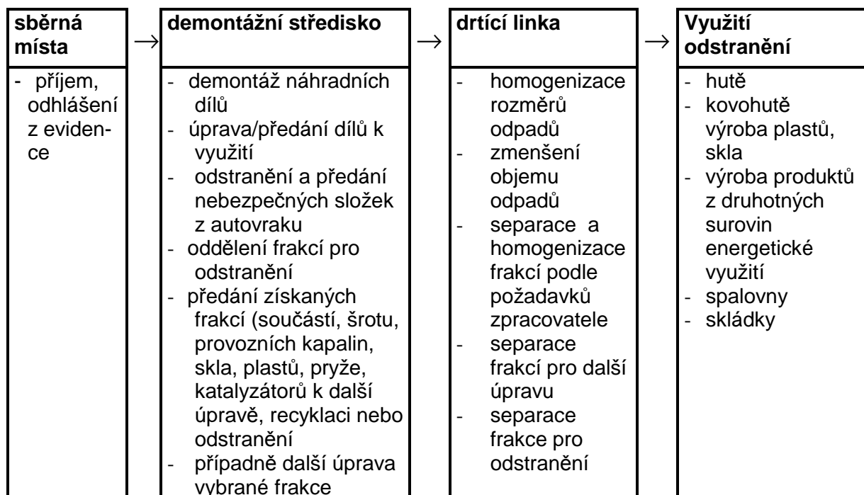
Obr. 2: Schéma nakládání s autovrakem
